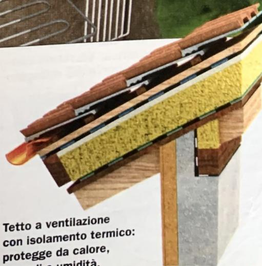
Tetto a ventilazione con isolamento termico: protegge da calore, incendi e umidità.
